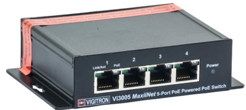
Mit dem Switch VI-3005 lassen sich vier Ethernet Ports 10/100BaseTX mit einem Uplink über UTP- oder LWL-Kabel absetzen. Neben der Möglichkeit die angeschlossenen Verbraucher direkt mit PoE zu speisen, kann der Switch selber ebenfalls über den Uplink-Port mit PoE ferngespiesen werden. Dank zeitsparendem "plug-and-play" ist keine Softwarekonfiguration notwendig. Die kleine Bauweise machen den VI-3005 sehr vielfältig einsetzbar.
